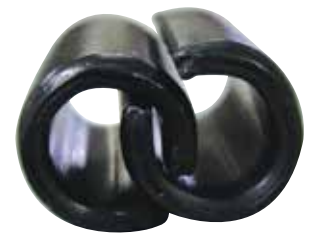
互相嵌套使直槽弹性圆柱销不能自动进给和装配。
