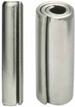
图 1. 左图为直槽弹性圆柱销，设计为“C”形。右图为卷制弹性圆柱销，具有 2 ¼ 圈的辊轧材料。
