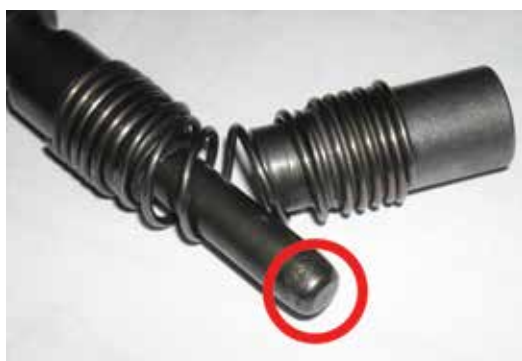
图 3. 磨损的插销顶杆
