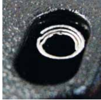
图 4. 使用不恰当的安装工具 将造成圆柱销出现伸缩或散 开现象。
