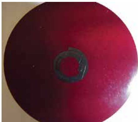
已安装好并抛光的卷制弹性圆柱销的照片。 该销现在已为显微硬度检测做好准备。
