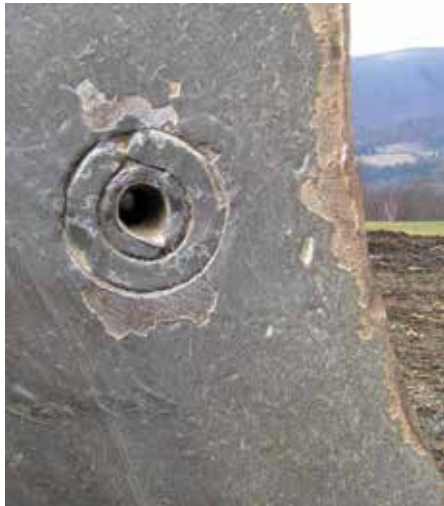
复合销：直槽弹性圆柱销相互成 180^\circ 角。
