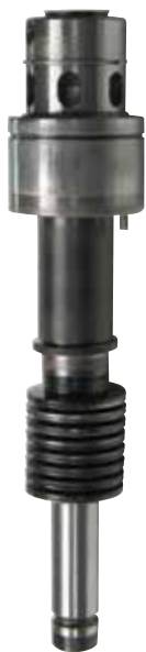
左图：碟形弹簧受压，夹头打开。 右图：碟形弹簧未受压，夹头关闭，工件夹紧。
