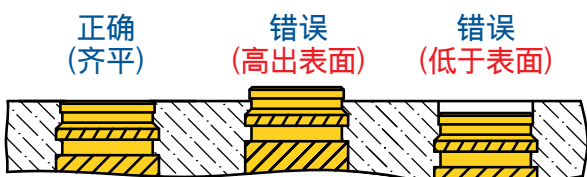
安装以后，嵌件顶部应尽可能与塑料表面齐平。
