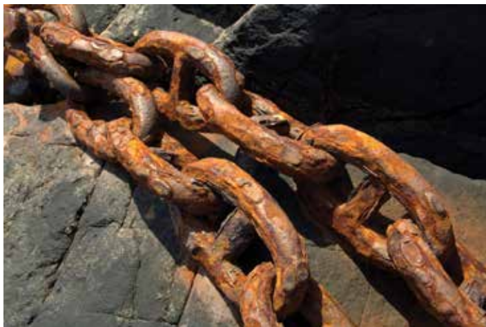
图1: 链条正在生锈，证明了铁锈或全面腐蚀导致材料损失。
