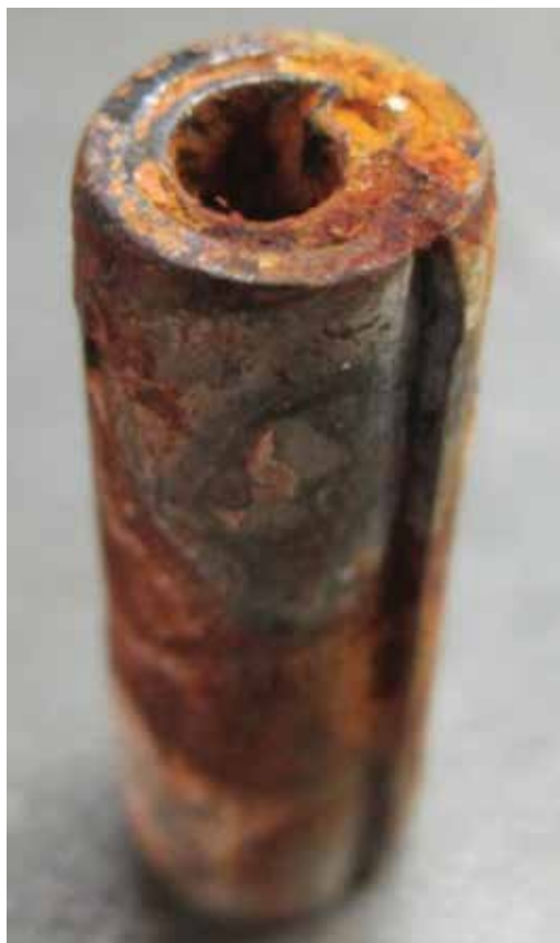
图3：照片显示了卷制圆柱销的基本几何结构——由多圈金属组成。镀层不能穿透金属圈和浸渍涂层之间的空间，尽管镀层能够覆盖内部，却不能有效覆盖销的金属圈之间的空间。
