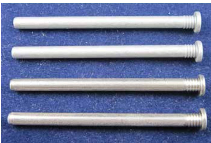
图5：销试验之前：上两根为有锌涂层的低碳钢；下两根为奥氏体305不锈钢。
