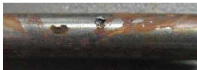
图7：420不锈钢直槽销出现点蚀，并伴有相关变色。
