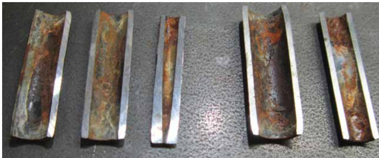
图4：下文为图3所示销横截后的照片，旨在展示钢质卷制圆柱销卷间的侵蚀。
