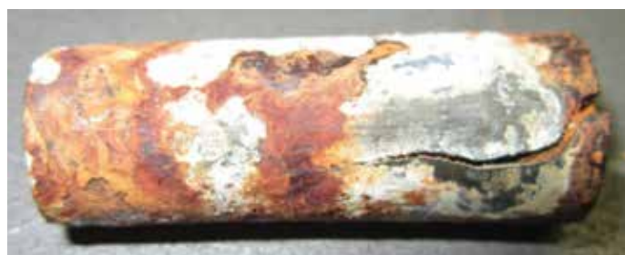
图2：卷制圆柱销先采用轻型镀锌，后采用铬酸盐浸渍工艺进行表面处理。经评定，表面处理工艺能提供48小时的“红色”腐蚀防护。零件在盐雾中放置200小时，出现了明显红锈，而部分锌和白色腐蚀仍然存在。虽然表面锌显露出来，但不管临近区域侵蚀多严重，零件依然未出现红锈。
