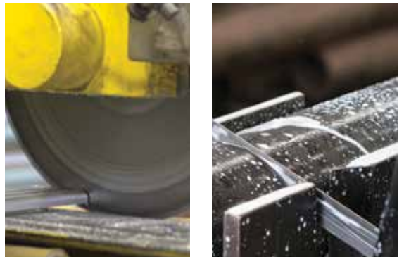
金属管切割示例
