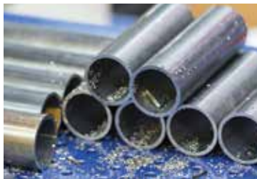
已切割金属管的末端毛刺
