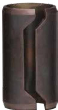
弹性定位销用于精确定位各个部件。它们使用心轴卷制成型，以确保圆形。建议将孔的公差的一半分配给固定销的一端的孔，另一半分配给相配合的孔。
